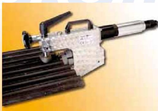
Depois das comprovadas fresas de coroa em material maço, a coroa provida de insertos reversíveis passou a ser produzida em série após vários ensaios abrangentes.
